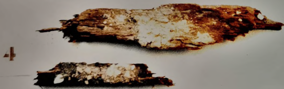
Fragment de virure dont la surface externe présente un détail d'assemblage des virures entre elles par languettes de bois.
