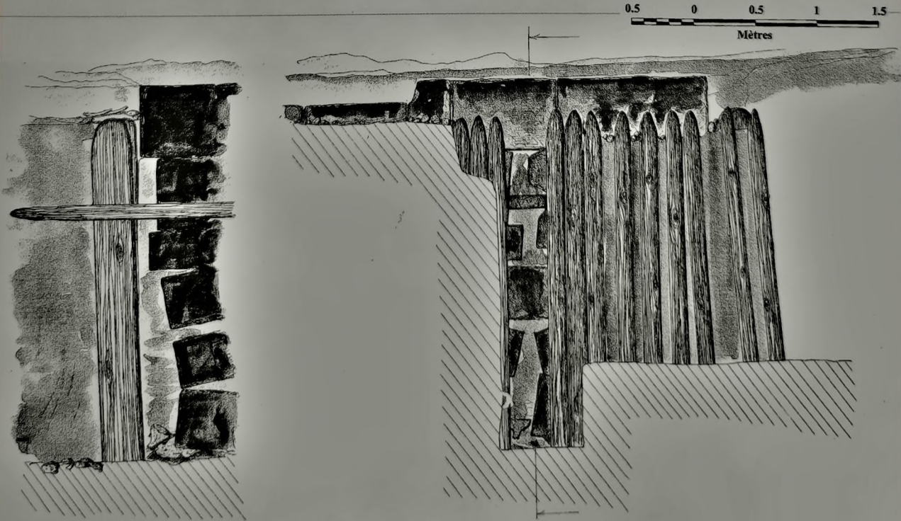
Coupe et vue de face du coffrage.
