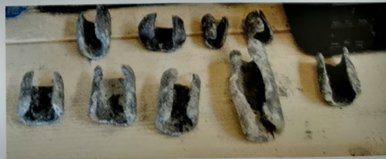
Lests de filet et barre de plomb servant à leur fabrication.
