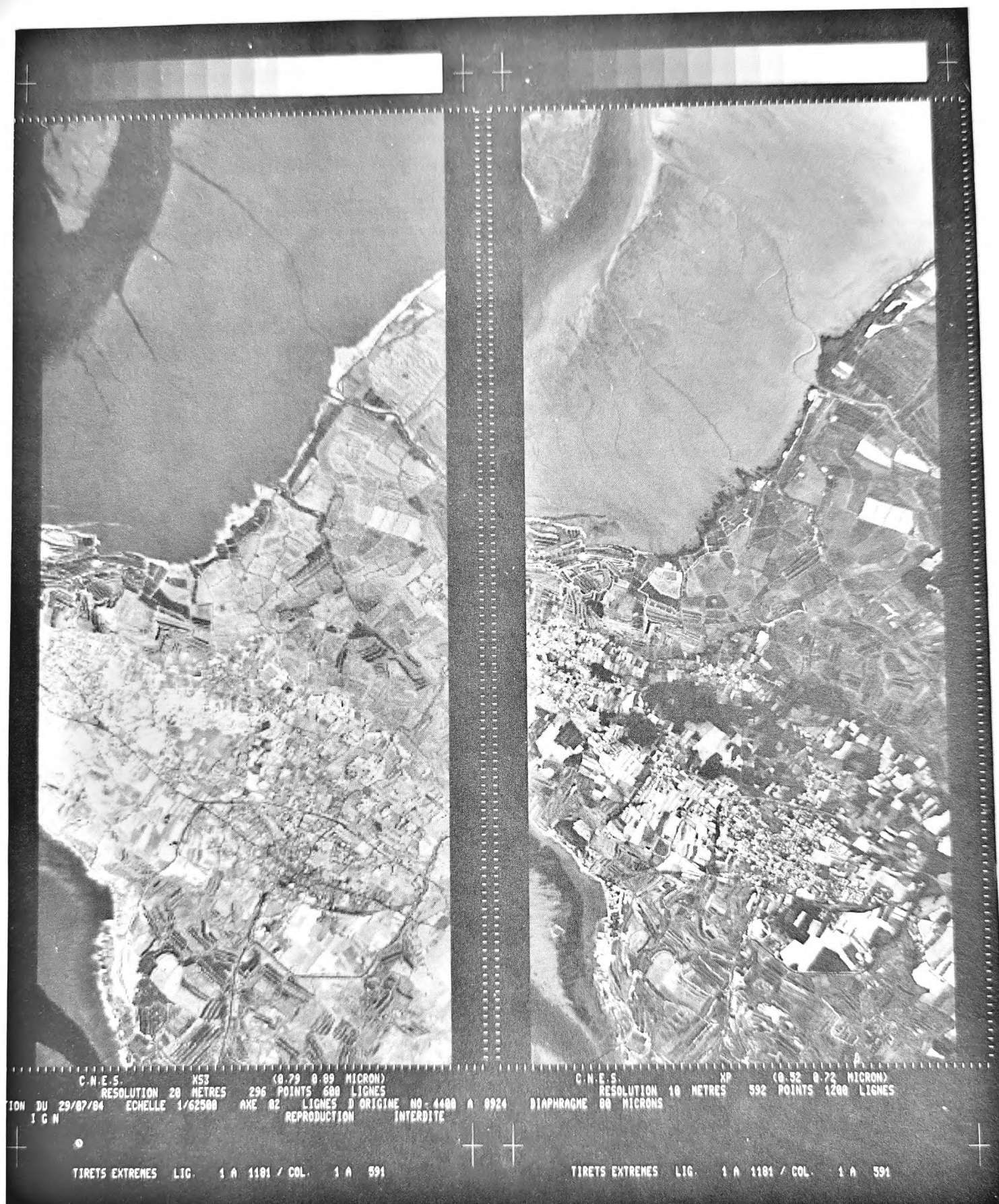
FIG. 9. — Simulation d'image du Satellite SPOT, vol GDTA 1984, sur la région de Marennes - A gauche, résolution 20 m dans le proche IR (0,8 - 0,9 \mu ), à droite résolution 10 m dans le canal panchromatique (0,5 - 0,7 \mu ).
